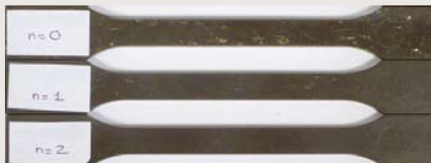
● Déchets fibreux incorporés par compoundage comme renfort dans une matrice en polypropylène. Ces éprouvettes illustrent les résultats obtenus avec différents traitements des rejets papetiers.
