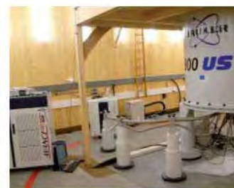
À gauche, diffractomètre de poudres, équipée d'une chambre haute température. Au centre, diffractomètre de rayons X. À droite, spectromètre RMN 900MHz///Textiles ///Text
